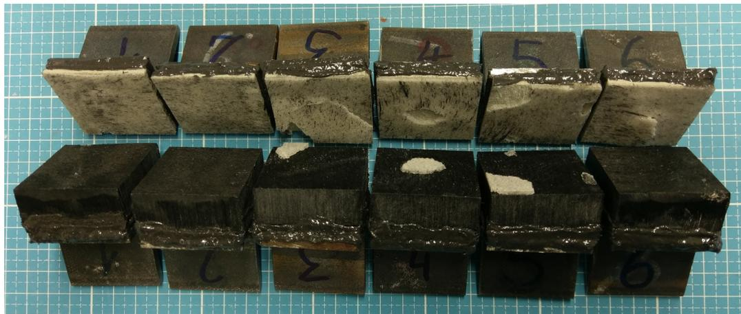
Abbildung 1: Bruchflächen der Prüfkörper nach dem Haftzugversuch
